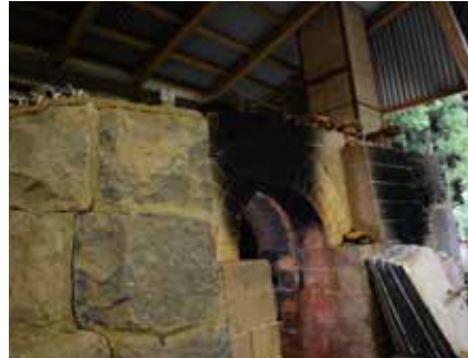
窯の出入り口、ここから窯詰め・窯出し・横焚きをします。
