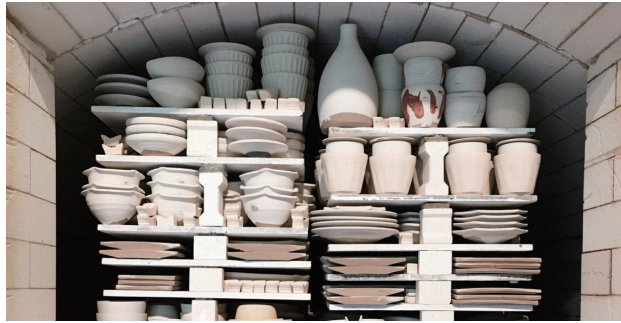
窯詰はぎっしり
