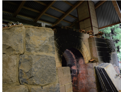
窯の出入り口、ここから窯詰め・窯出し・横焚きをします。
